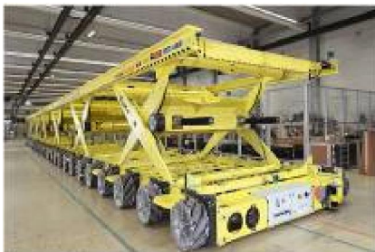
ILUSTRACIÓN 52. VEHÍCULO OMNOMOVE EMPLEADO POR AIRBUS E UNA DE SUS PLANTAS. FUENTE: KUKA ROBOTICS
