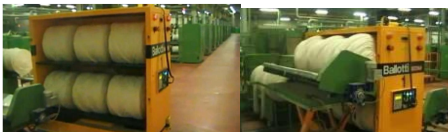
ILUSTRACIÓN 50. AGV CARGANDO BOBINAS DE LANA. FUENTE: AGVIA 50 (BALLOTTISISTEMI.COM)
