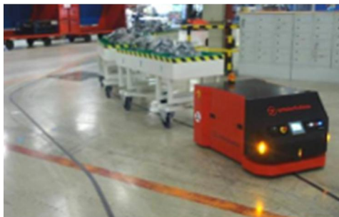
ILUSTRACIÓN 9. EJEMPLO DE GUIADO DE AGV MEDIANTE CINTA MAGNÉTICA. FUENTE: ROBOTEQ
