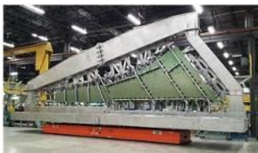
ILUSTRACIÓN 51. VEHÍCULO OMNIMOVE DE KUKA TRANSPORTANDO PIEZA AERONÁUTICA DE BOEING. FUENTE: ADVANCED MANUFACTURING
