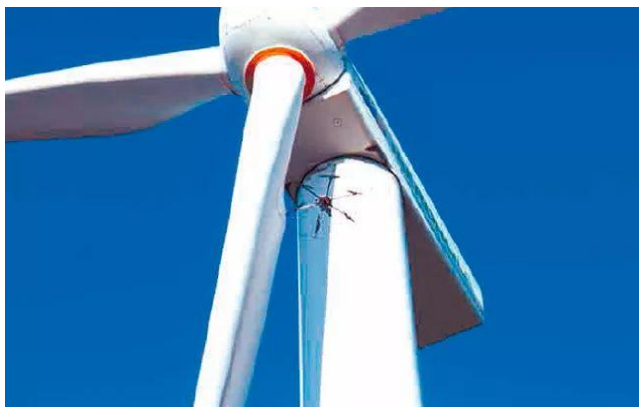
ILUSTRACIÓN 61. ARACNOCÓPTERO INSPECCIONANDO UN AEROGENERADOR. FUENTE: CARLOS BERNABÉU/ARBOREA INTEL BIRD
