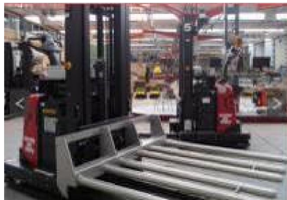
ILUSTRACIÓN 44. AGVS EMPLEADOS PARA TRANSPORTE PALLETS EN INDUSTRIA ALIMENTARIA. FUENTE: ASTI 45
