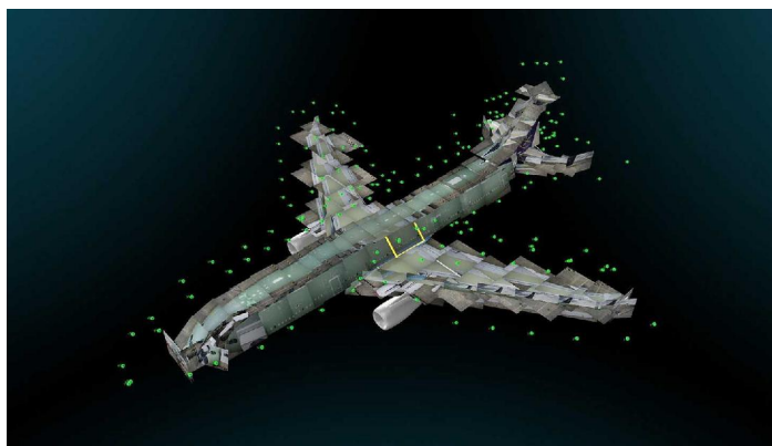
ILUSTRACIÓN 60. MODELO 3D BASADO EN IMÁGENES TOMADAS CON UN DRONE. FUENTE: ASCTEC
