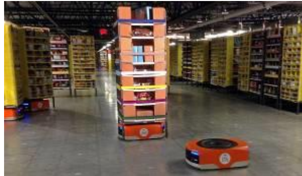
ILUSTRACIÓN 54. EJEMPLO DE AGV UTILIZADO POR AMAZON EN SUS ALMACENES DE DISTRIBUCIÓN. FUENTE: AMAZON
