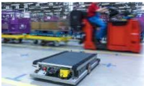
ILUSTRACIÓN 45. EJEMPLO DE AGV EN LAS INSTALACIONES DE BMW. FUENTE: BMW GROUP
