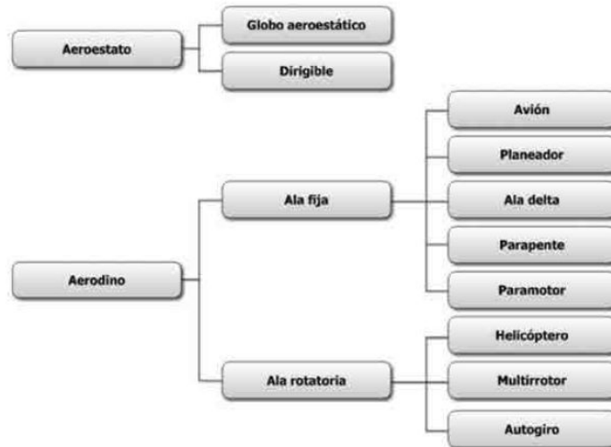
ILUSTRACIÓN 28: CLASIFICACIÓN AERONAVES POR SU FORMA DE SUSTENTACIÓN. FUENTE: MANUEL OÑATE DE MORA
