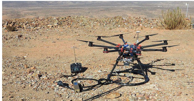
ILUSTRACIÓN 62. EJEMPLO DE DRONE UTILIZADO PARA EXPLORACIÓN MINERA. FUENTE: GEOMAGDRONE
