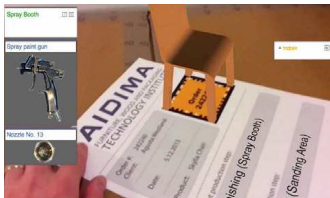
ILUSTRACIÓN 12: EJEMPLO DE UNA ORDEN DE TRABAJO INTEGRANDO LA RA DEL PRODUCTO A TRATAR Y LAS HERRAMIENTAS NECESARIAS, ASÍ COMO LOS PASOS A SEGUIR. FUENTE: AIDIMME.
