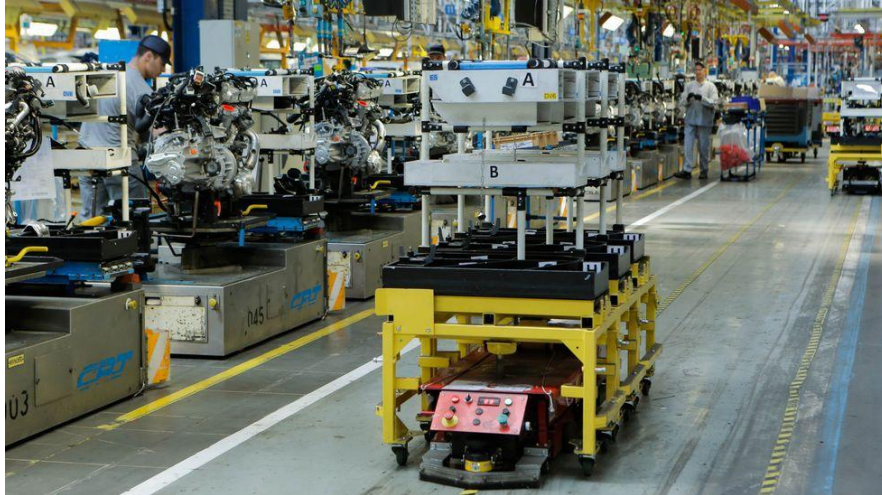
ILUSTRACIÓN 16: AVGs EN LA PLANTA DE PSA VIGO. FUENTE: FARO DE VIGO
