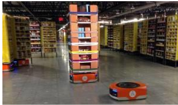
ILUSTRACIÓN 13 : EJEMPLO DE AGV UTILIZADO POR AMAZON EN SUS ALMACENES DE DISTRIBUCIÓN. FUENTE: AMAZON.
