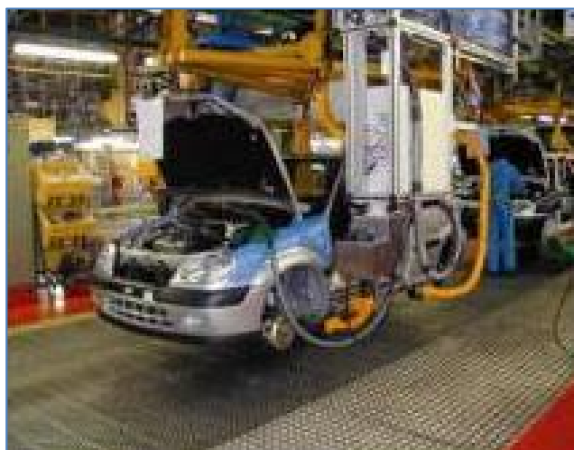
ILUSTRACIÓN 22: LLENADO DE CIRCUITOS. FUENTE: MASTER EN INGENIERÍA DE LA AUTOMOCIÓN, UNIVERSIDAD DE VIGO
