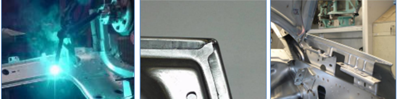
ILUSTRACIÓN 18: FASE DE FERRAJE. FUENTE: MASTER EN INGENIERÍA DE LA AUTOMOCIÓN, UNIVERSIDAD DE VIGO
