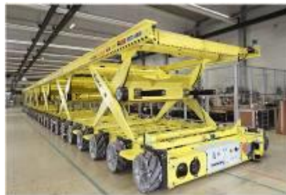
ILUSTRACIÓN 3: VEHÍCULO OMNOMOVE EMPLEADO POR AIRBUS E UNA DE SUS PLANTAS. FUENTE: KUKA ROBOTICS
